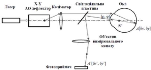
Рис. 1. Спрощена функціональна схема aberометру рейтрейсингового типу [4, с. 181]
